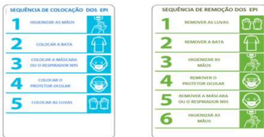
Figura 1 – Sequência de colocação e remoção dos EPI's.
