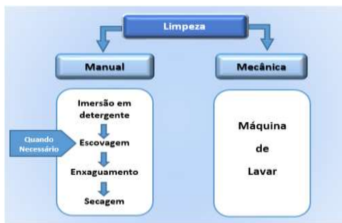
Figura 1 – Processo de limpeza manual e mecânica.
